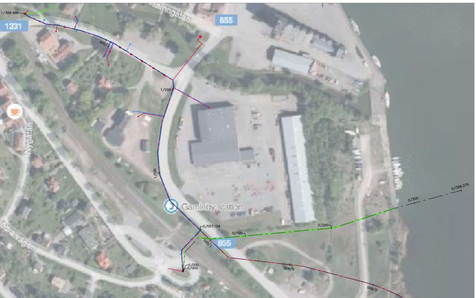
Figur 9. Röd ledning, spillvattenledning (tryckavlopp) 0/800-1/400 samt grön ledning dagvattenledning PST2 Brädd 0/000-0/356. Källa kartunderlag: www.hitta.se samt Figur 1 enligt Tyréns utredning.
