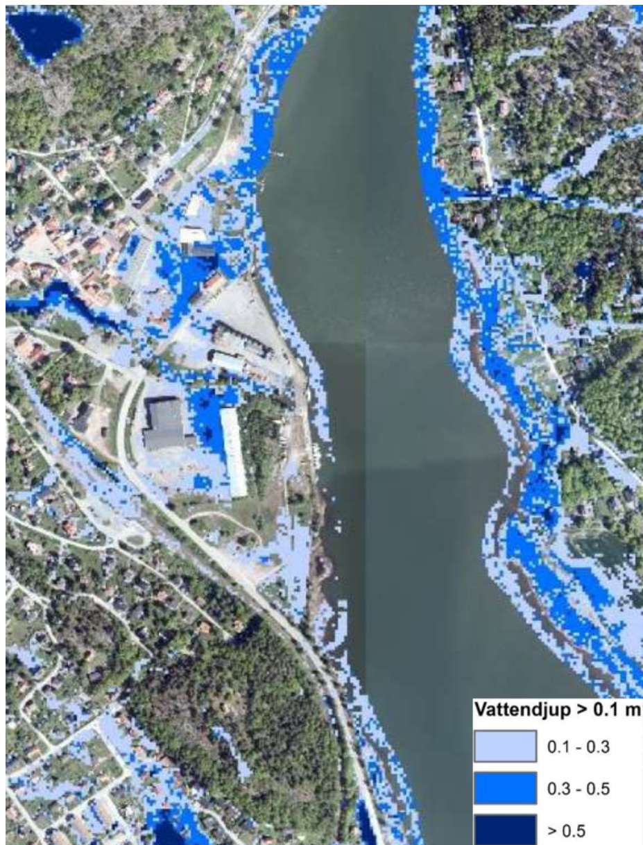
Figur 4. Max vattendjup vid skyfallsöversvämning, källa Tyréns AB.
