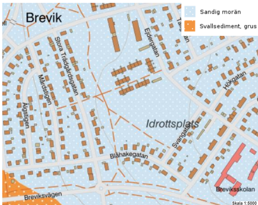
Figur 9. Inom planområdet är det övervägande karterat sandig morän men geoteknik har visat att jordlagerföljden kan variera stort med inslag av både sand och finkorniga jordarter. Utdrag ur jordartskarta 1:25000-1:200000 (Källa: SGU)
