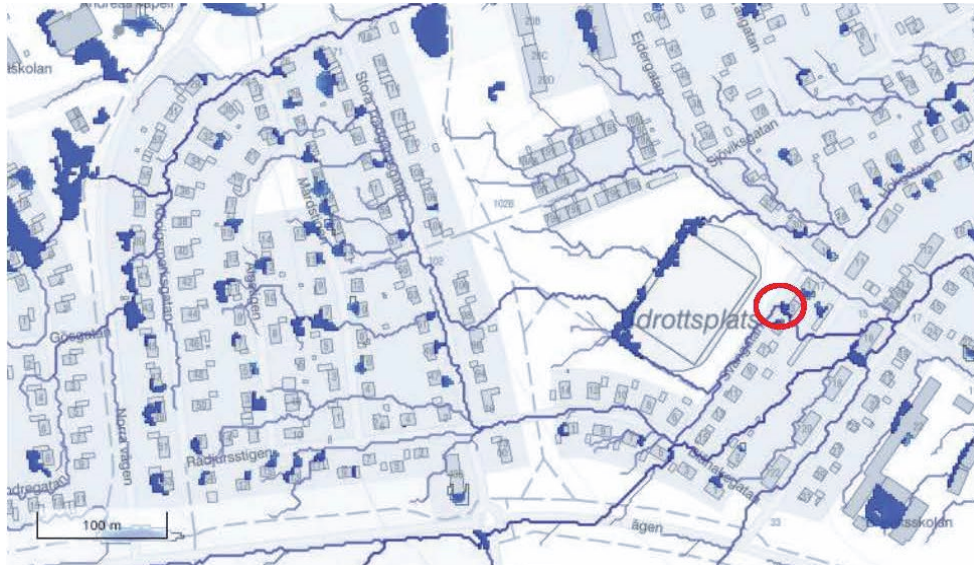
FIGUR 13: Befintlig utjämningsvolym vid fotbollsplanen och mer detaljerade rinnvägar. Fastighet utmed Svängatan som initialt riskerar att drabbas nedströms planområdet är markerad i rött (Dagvattenutredning, Tyréns).
