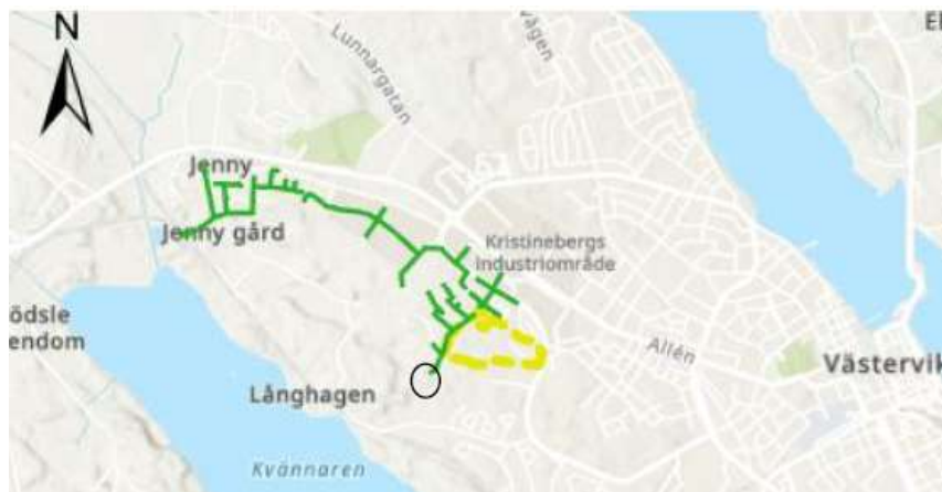
FIGUR 25: Dagvattennät som tidigare utretts med påvisade risker för dämning. Markerat utlopp redovisat som svart cirkel på kartan har varit föremål för studerad dämningrisk i utloppsläge vid Vattentornsvägen.
