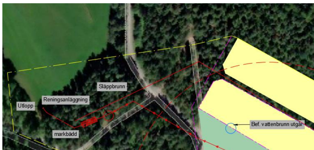
Figur 14. Föreslagen placering av reningsanläggning. Reningsanläggningen föreslås ha utlopp mot åker och vidare till Gudingan.
