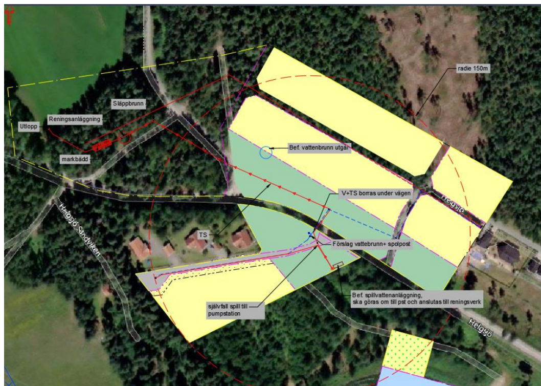
Figur 18. Föreslagen ledningssträckning för VA. Se även Bilaga1.
