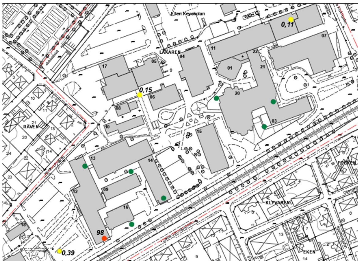
Figur 20. Tetrakloreten i markgas. Mät punkt L med förhöjt mätvärde markerad med blå pil
