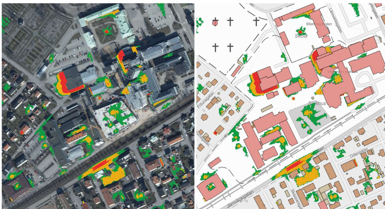
Figur 36 och 37. Datasimulering i program Scalgo skyfall 100 mm resp. 50 mm.
