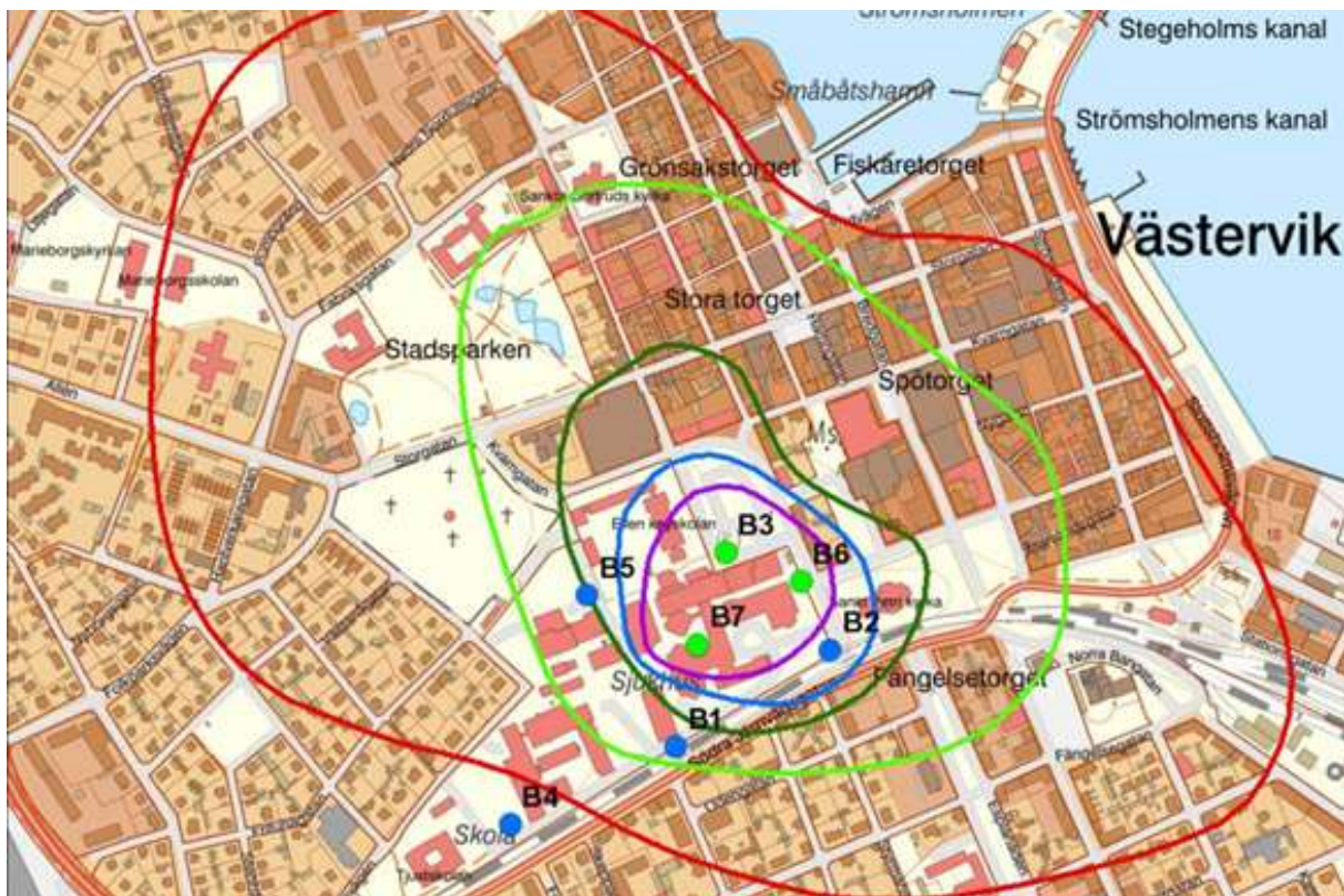
Figur 16. Influensområde, påverkan av grundvattennivåer vid vattenuttag från bergvattenrör B3, B6, B7 (gröna punkter). Även bergvattenrör B1, B2, B4, B5 (blå punkter) används för periodisk övervakning/ provtagning-kem.lab.analysis Analysdata för grundvatten B4 indikerar spridning av kontaminerat grundvatten från den gamla kemtvätten.
