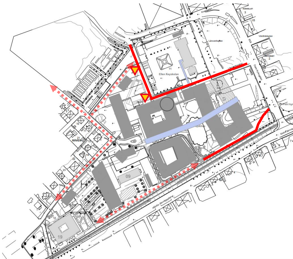
Figur 15. Angöringsvägar för ambulans (helldragen röd linje) och räddningsvägar/redundansvägar (streckad linje).
