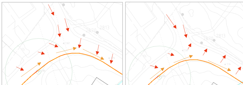
Figur 15. Figur till vänster illustrerar flödesriktningen i korsningen norr om planområdet i nuläget, vilket fortsatt kan medföra att uppströms ytledes avrinning tar sig in i planområdet. Figuren till höger illustrerar flödesriktning efter föreslagen omsvevning av gatan.
