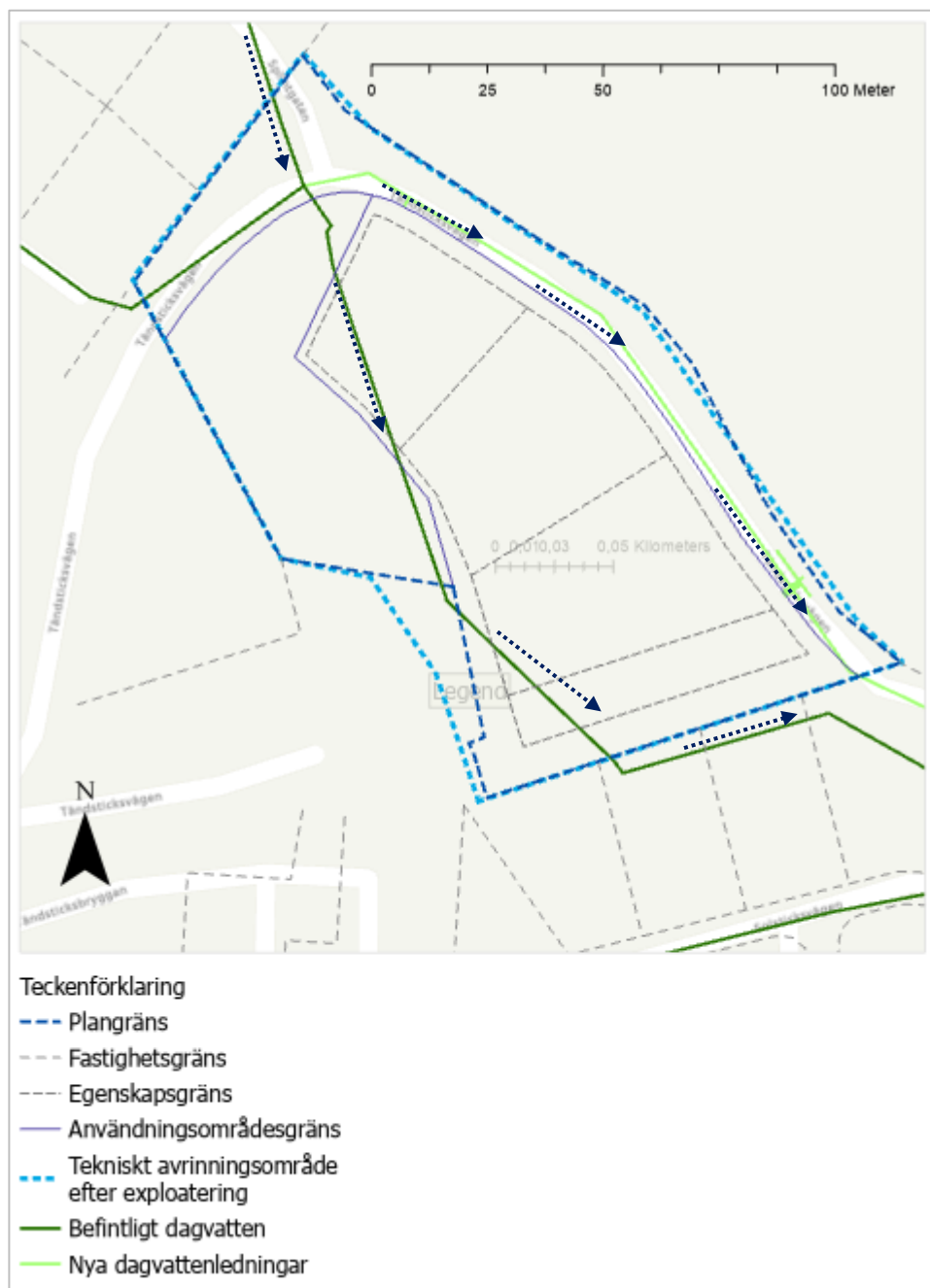
Figur 8. Tekniskt avrinningsområde och befintliga ledningar i aktuellt planområde. Blå pilar motsvarar flödesriktningen i dagvattennätet (ArcGIS Pro, 2023).
